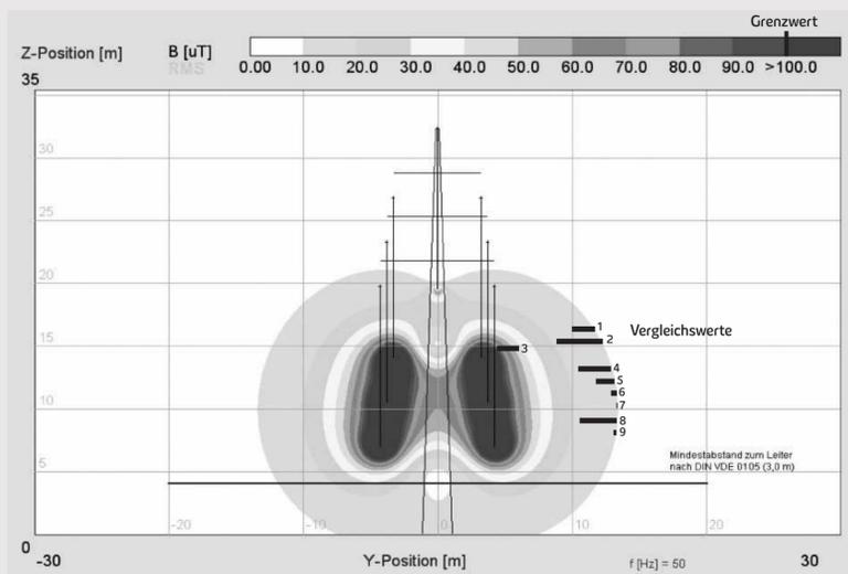
Keine relevante magnetische Flussdichte mehr messbar nach ca. 13 Metern
