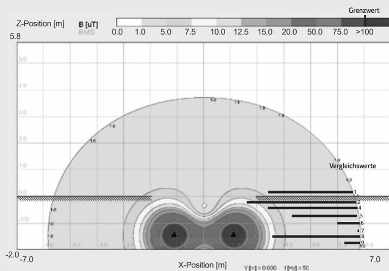
Keine relevante magnetische Flussdichte mehr messbar nach ca. 5 Metern
