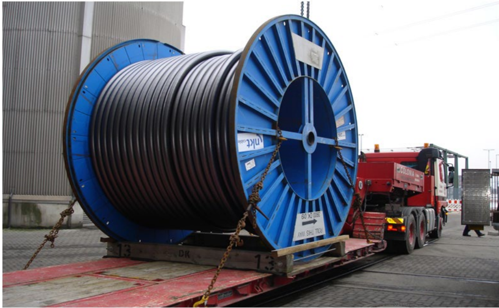
Foto 2: Spezialtransport einer 110-kV-Kabeltrommel vom Kabelwerk zur Baustelle (Beispielfoto, Quelle: Fa. nkt cable)
